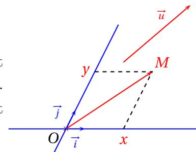
**Remarque :** Ainsi, dire que les coordonnées de  $\vec{u}$  dans le repère  $(O; \vec{i}, \vec{j})$  sont  $(x; y)$  signifie que  $\vec{u} = x\vec{i} + y\vec{j}$ . (On dit aussi que  $(x; y)$  sont les coordonnées de  $\vec{u}$  dans la base  $(\vec{i}, \vec{j})$ ).
